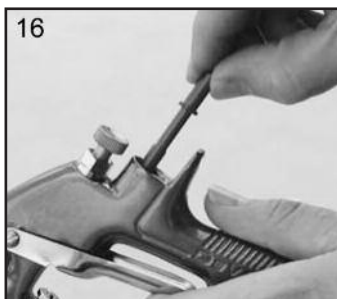
16. Vuelva a colocar el husillo de la válvula de aire (11).
