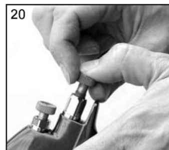
20. Ponga en su lugar el muelle de la aguja de fluido (8) y el tornillo de ajuste de la aguja (7).
