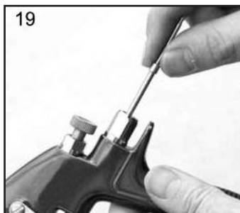
19. Monter l'aiguille de liquide (9).
