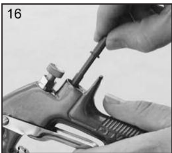
16. Reposer l'axe du clapet d'aération (11).
