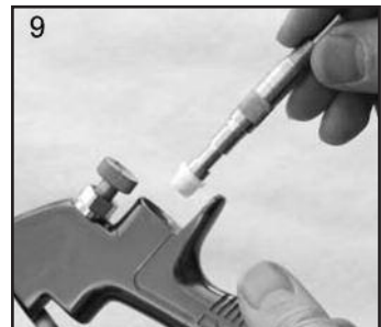
9. Monter le joint de clapet d'aération avant neuf sur l'outil d'entretien de façon à ce que la rainure soit face à la poignée de l'outil.
