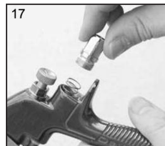
17. Vuelva a colocar el resorte de la válvula de aire insertando el extremo pequeño del resorte en la pistola y el tornillo en el alojamiento (10).
