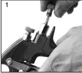
1. Quite el tornillo de ajuste de la aguja (7), el muelle de la aguja de fluido (8) y la aguja de fluido (9).
