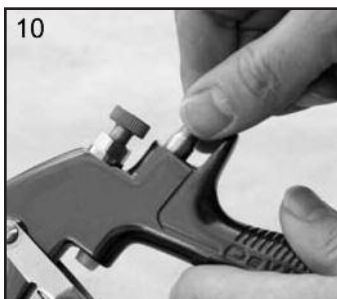
10. Monter le joint de clapet d'aération avant neuf sur le corps du pistolet et appuyer fermement pour s'assurer que le joint est bien engagé.
