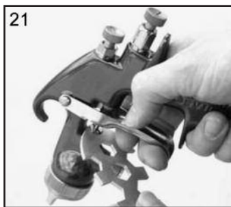
21. Resserer la garniture d'étanchéité du pointeau(4) à l'aide des tricoises suffisamment pour bien sceller, mais tout en permettant le libre mouvement du pointeau. Lubrifier à l'aide de lubrifiant à pistolet pulvérisateur.
