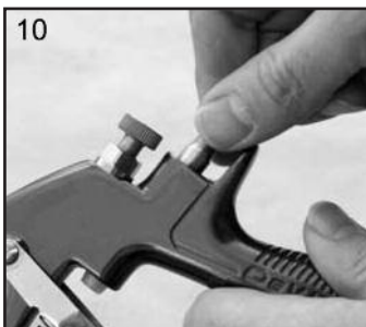
10. Ponga la nueva junta delantera de la válvula de aire en el cuerpo de la pistola y oprima con firmeza para asegurar que la junta esté enganchada.
