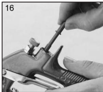
16. Replace Airvalve Spindle (11).
