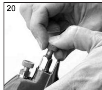
20. Monter le ressort de l'aiguille de liquide (8) et la vis de réglage de l'aiguille (7).
