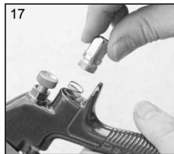
17. Reposer le ressort du clapet d'aération en introduisant la petite extrémité du ressort dans le pistolet, et visser le boîtier (10).
