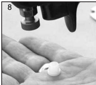
8. Retourner le pistolet et laisser le joint tomber.
