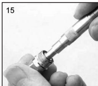
15. Ponga la junta trasera de la válvula de aire en el alojamiento (10).
