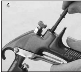
4. Retirer l'axe du clapet d'aération (11).
