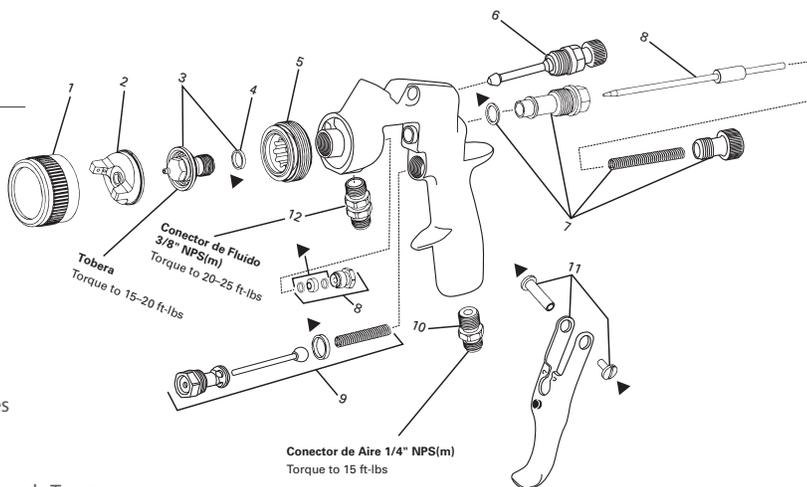
803527 FLG4-488-K ▼ FLG4 Kit de Reparación para pistola (contiene 1 pieza: Sello de Tobera, Empaque de Aguja, Perno de Gatillo, Tornillo de Gatillo, y Empaques para Válvula de Aire & Buje de Aguja.)
